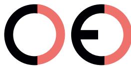
Marca CE falsa (demasiado separados)
